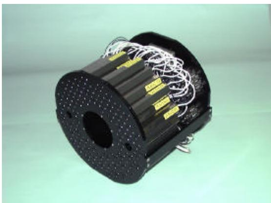
図2.7: 疑ラピディティ領域で  $\pm 3.1 < \eta < \pm 3.9$  の領域を覆う2対1対のBBCの片側の全体写真。64本のチェレンコフ検出器により構成され、優れた時間分解能をもつ。中心はビーム軸を通せるように空洞になっている。
