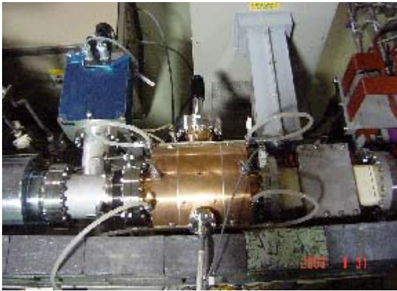
Photo 1 上から撮ったRF空洞の写真である。 電子は右から左へ周回している。
