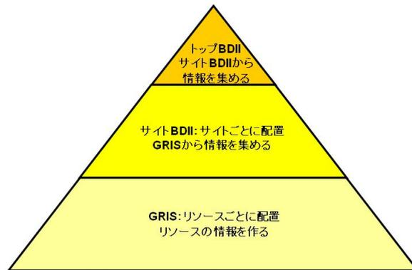
図 3.3: 情報サービスの構成。トップ BDII、サイト BDII、GRIS が階層構造を成している。
