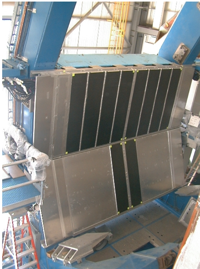
図 2.15: 組み立てられた TOF East 黒い部分が 1 枚のパネルで、T 字型に 10 枚並べられている。
