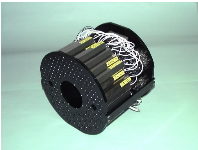
図 2.5: BBC 検出器の写真 64 個の素子を組み上げたところ
