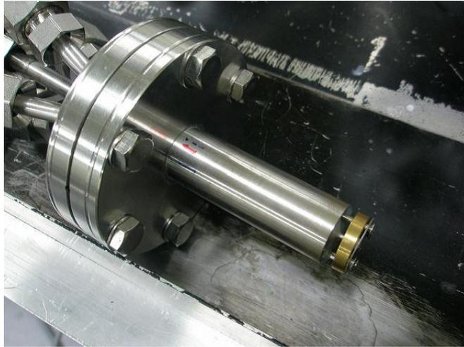
図 4.5: 光ファイバーとカメラの接合部。先端の治具の中にレンズが並べてある。
