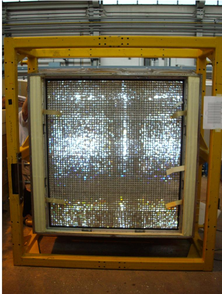
図 3.6: 2009 年 7 月の組み立て途中の PHOS 検出器 (1.2m × 1.4m)。1 モジュールあたり  $56 \times 64 = 3584$  個のクリスタルが見える。
