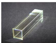
図 9: PWO 結晶  $22 \times 22 \times 180\text{mm}^3$
