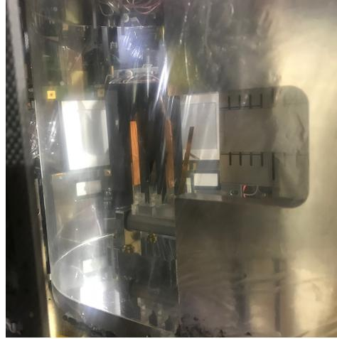
(b) ターゲットチェンバーの外から撮影した標的の写真。写真中の右手前から左奥への方向でビームが入射し3枚の標的を通過する。Run 0 では右から、銅、炭素、銅の順に配置している。
