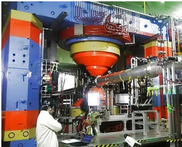
(a) Run 0a でのセットアップ。写真左奥にあるのが FM 電磁石と検出器であり、右手前から陽子ビームを入射する。
