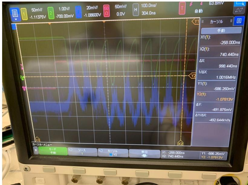
図 4.1 GTR-ASD テスト基板での発振の様子。上の緑の線がトリガー用デジタル信号出力の波形、下の青の線がアナログ端子の出力の波形、赤のステップ状の線が入力しているテストパルスと同期した信号波形である。
