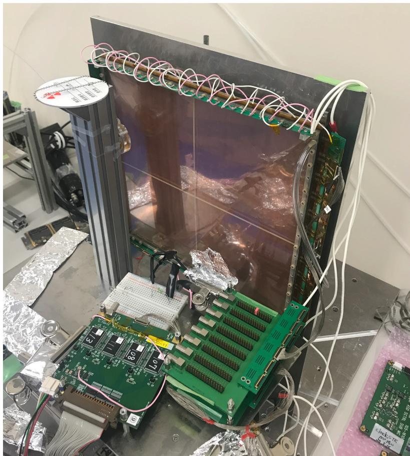
図 B.2 セットアップ (図 5.3.4 の再掲)。 $^{55}\text{Fe}$   $\gamma$  線源をチェンバーの前に設置し、チェンバーの GEM が放電するのを待った。GTR-ASD の放電保護チップの性能を調べるために、ブレッドボード上の回路で抵抗を接続した。
