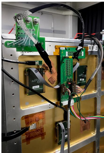
図 3.6 HBD の読出回路の写真。中央のコの字型の基板が HBD-ASD 基板、左右に 2 つ下に 1 つ接続しているのが RD51-APV 基板、左上についているのが高電圧分割基板である。
